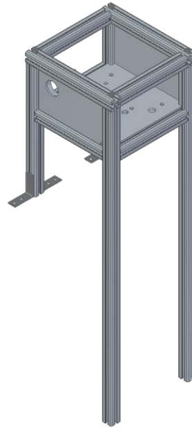
Figuur 138 Frame met bovenruimte en montage hoekjes
